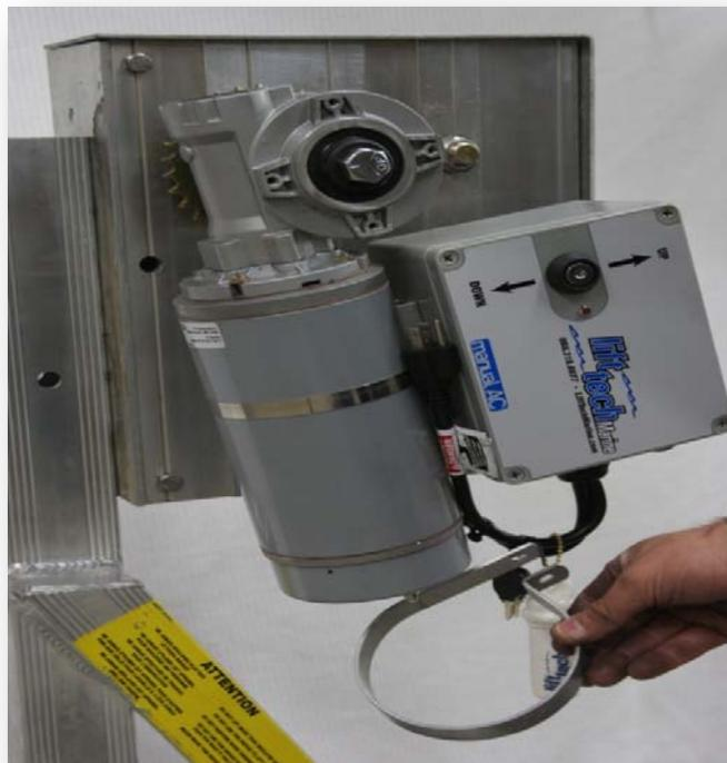
**N°7** Fixer l'étrier au support avec les vis puis brancher le moteur et profitez.
