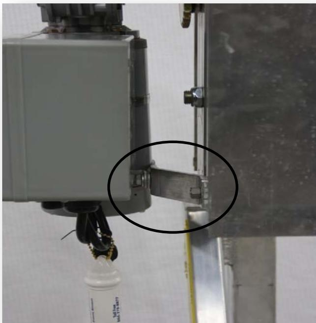
**N°8** En cas de panne utiliser cet outil à l'aide d'une visseuse pour monter ou descendre l'élévateur.
